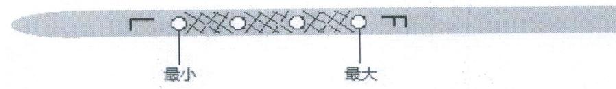
图 11 机油尺液位标度
