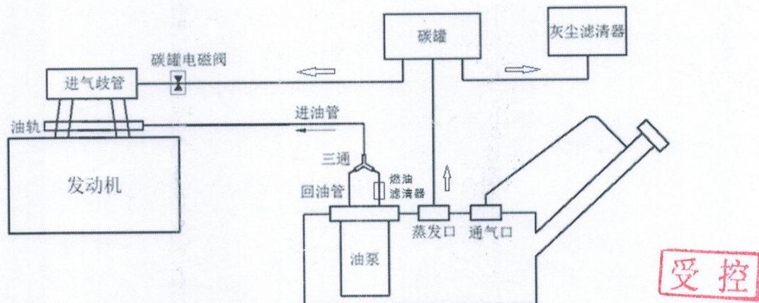
图 7 燃油系统连接图
