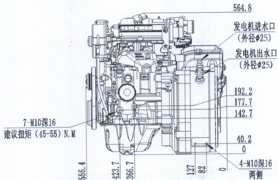
图 3：增程器机组安装尺寸
