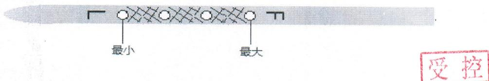
图 14 机油尺液位标度
