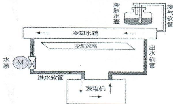
图 6：发电机独立水路安装示意图
