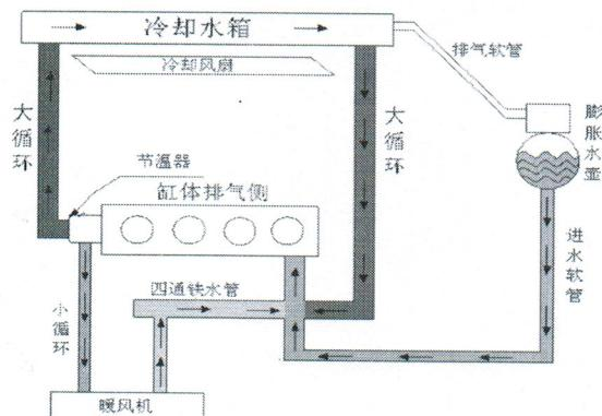
图 5：发动机水路安装示意图
